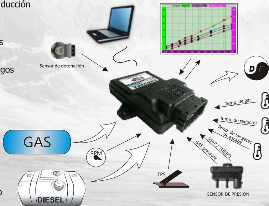
Diagrama de conexión del Sistema VELA Diesel
